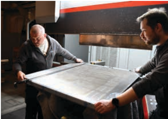
Steffen Kurch (l.) und Pascal Rokitta, Konstruktionsmechaniker der Firma Hauke, bei der Arbeit am Einrichteteil für das Abkanten der Namenstafeln.
